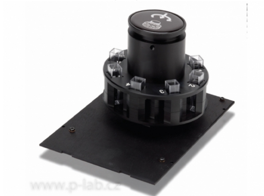
Automatický posuvný držák na 8 kyvet
