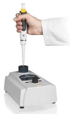
Testování těsnosti jednokanálové pipety pomocí PLT jednotky
